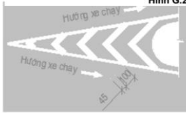
Hình G.28 - Minh họa cách vẽ vạch kênh hóa dòng xe dạng chữ V
