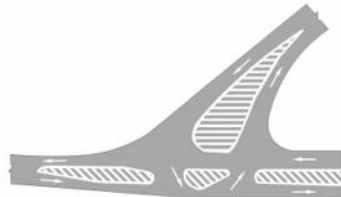
Hình G.31 - Bố trí vạch kênh hóa dòng xe ở ngã ba phức tạp
