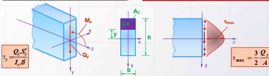
$Q_y$  Lực cắt trên mặt cắt ngang (The vertical shear in the transverse section shown)
