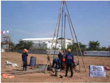
Hình 7.1. Khoan khảo sát ĐCCT
