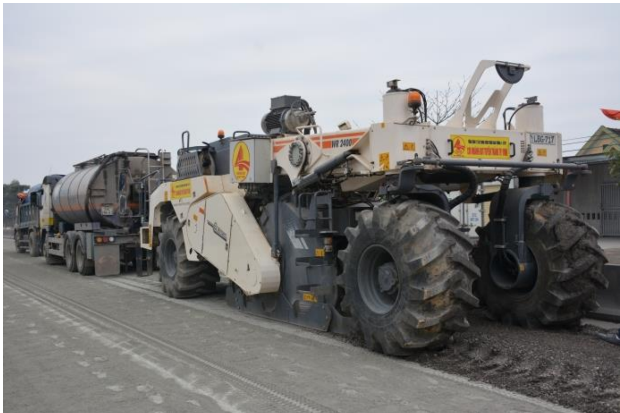
Thiết bị máy cào bóc tái chế nguội mặt đường bê tông nhựa WR2400 của Tổng công ty XDCTGT4
